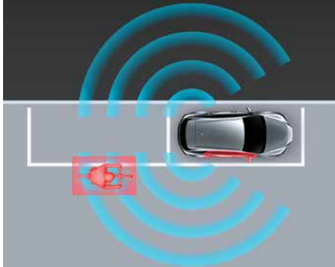
— Radar de verificação de perímetro (Safety Exit Assist - SEA).
